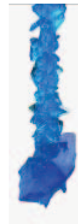
Рис. 5. Кристалл до и после удаления побочных кристаллов
