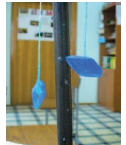
Рис. 6. Монокристаллы, выращенные в н. у. (слева) и в магнитном поле (справа)
