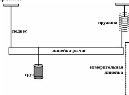
Очевидная установка показана на схеме и собрана на торце вашего стола. Изменяя положение точки подвеса груза ( $x$  - расстояние от точки крепления линейки до точки подвеса груза) можно изменять силу, действующую на пружину.
